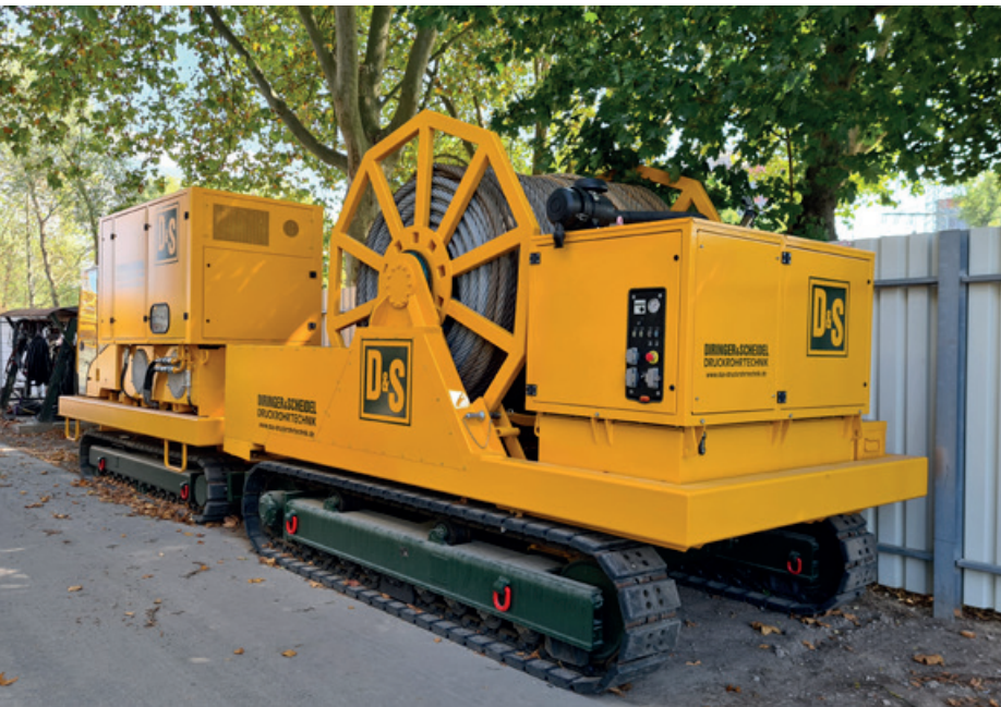
100t Seilwinde für Rohreinzug
